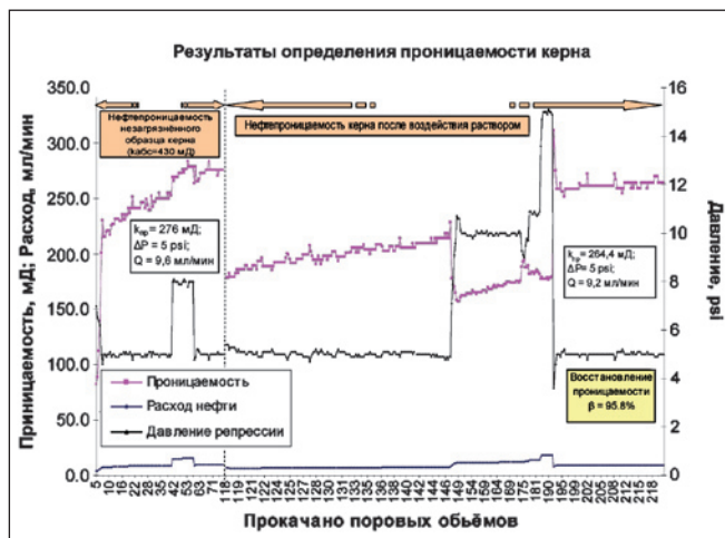
Рис. 4. Влияние бурового раствора на проницаемость по нефти призабойной зоны пласта
